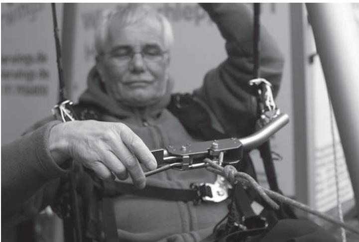
Zur Auslösung betätigt man den unteren längeren Hebel.
