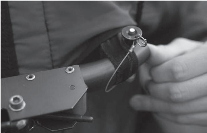
Für die Quickpins bohrt man Löcher mit Durchmesser 6,5 mm mit einem Abstand vom Rohrende von 20 mm. Die Nutzlänge der Quickpins beträgt 32mm. Zur Sicherung unbedingt die Endkappen aufsetzen!
