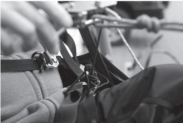
Das Gummi verhindert ein Hochschnellen der Klinke beim Auslösen. Die Schlaufe wird entsprechend gelegt und in den rechten Beingurt eingehängt.
