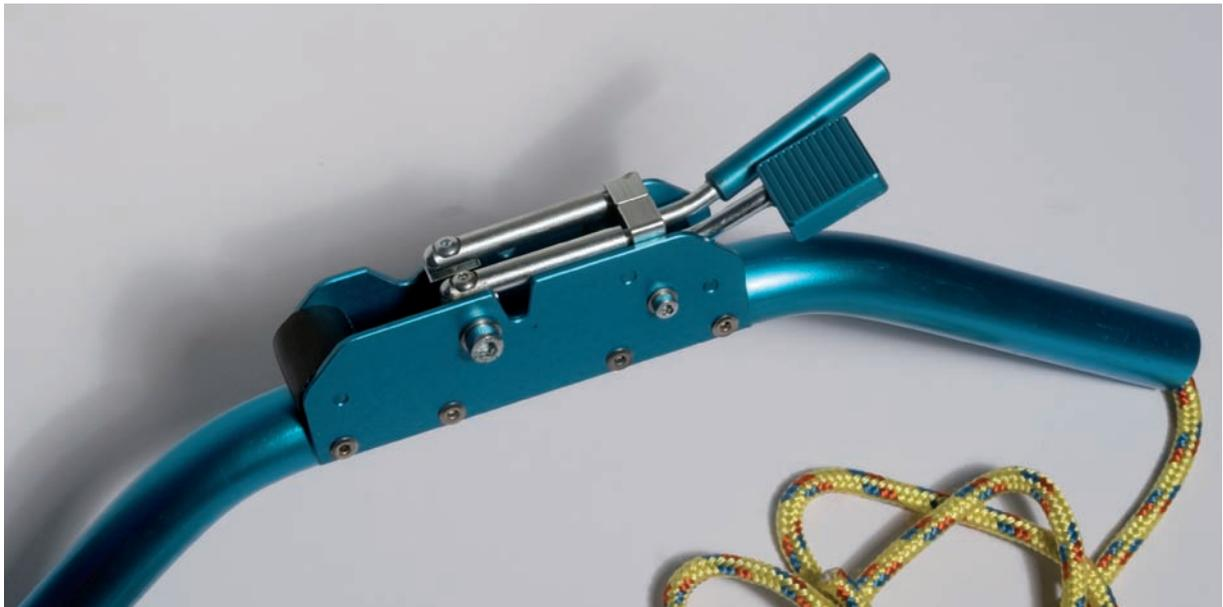
Die Link 2 ist eine zweistufige Klinke für den Winden- und UL-Schleppstart mit dem Hängegleiter und dem Windenstart mit dem Gleitsegel. Sie ist so stabil gebaut, dass sie auch für den Doppelsitzer HG zugelassen ist.
