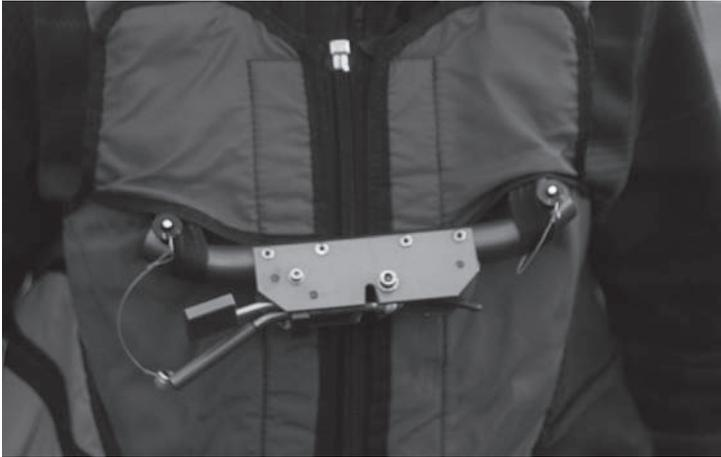
Das Spreizrohr wird so weit gekürzt, dass es auf jeder Seite etwa 30 – 40 mm aus den Schlaufen herausragt.
